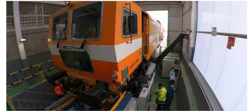
das en cada momento sin desmontar ni los ejes ni los bogies. Esto reduce el tiempo para devolver el vehículo a sus condiciones operativas. El proveedor del torno, automático y programable, es el líder del mercado español Patentes Talgo.
